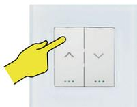
**Límite superior: Presione el botón Subida y ajuste la posición girando la varilla en la dirección indicada.**
