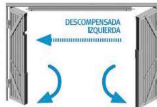
Modelo 11 2 Hojas descompensadas, Izquierda
