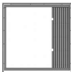
Modelo 14 Corredera Derecha, No Abatible. No Levanta guía.
